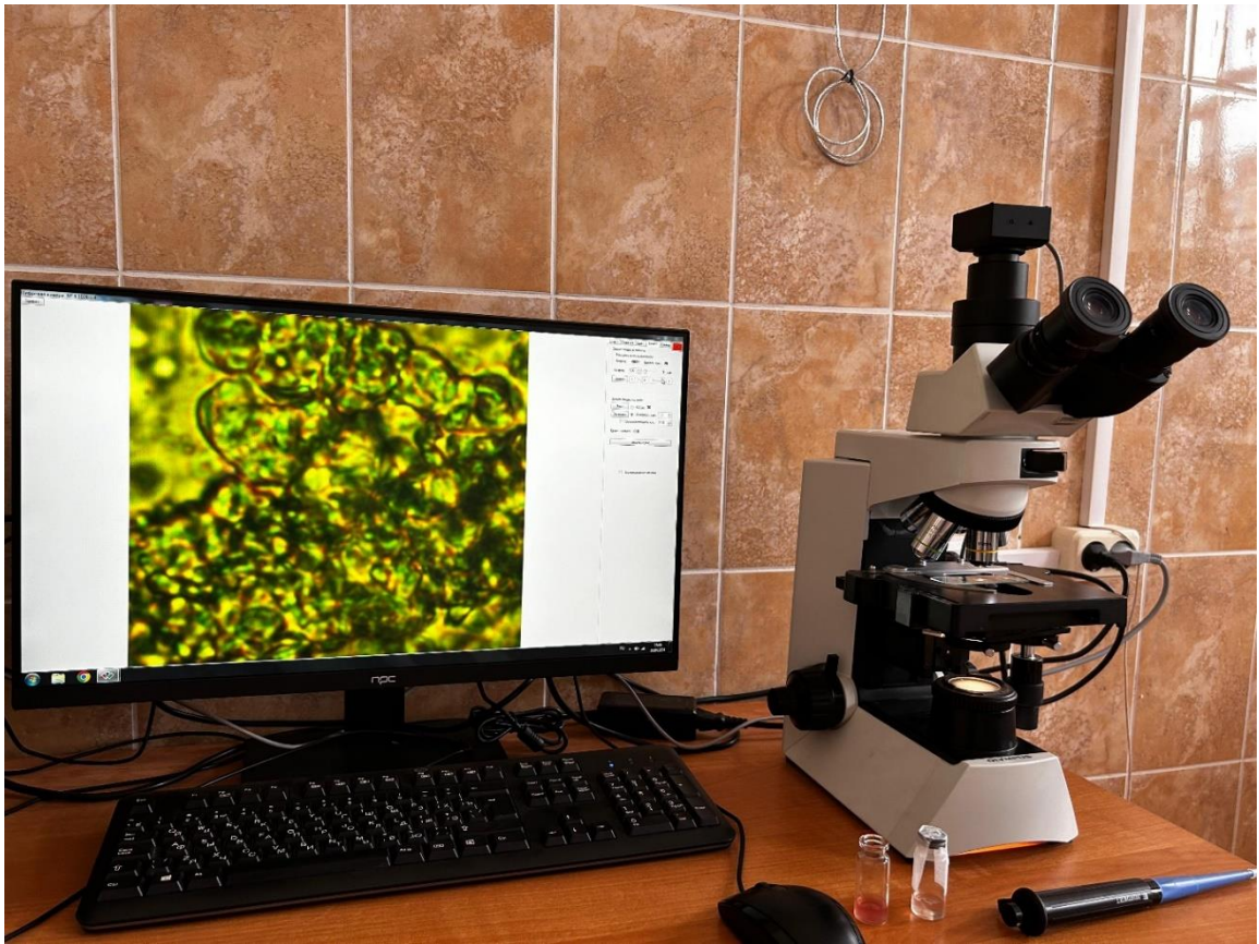
Рисунок 20 – Аппаратный комплекс (Персональный компьютер с установленной программой MMC Multimetr 3.0 подключенный к биологическому микроскопу Olympus CX41 с встроенной электронной видеокамерой MMC Multimetr)
