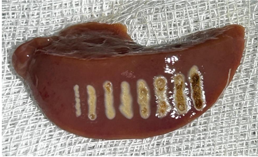
Рисунок 3 – Экспериментальный образец свиной печени после дистанционного линейного поверхностного лазерного воздействия при мощности от 0.5 Вт до 4 Вт
