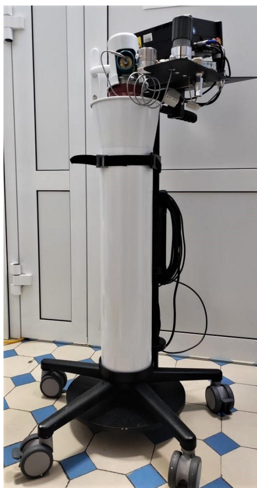
Рисунок 3 – Аксессуар FlowControl – система подачи газа для работы лазера в расширенном режиме
