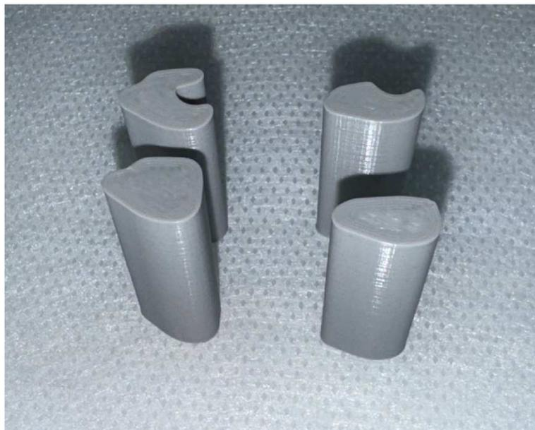
Рисунок 2.8 – Фотография распечатанных по чертежам лекал (применимых как для правого, так и для левого уха), подготовленных к стерилизации
