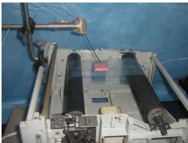
Рисунок 6 – Лентопротяжный механизм со стойкой для фиксации волоконного инструмента
