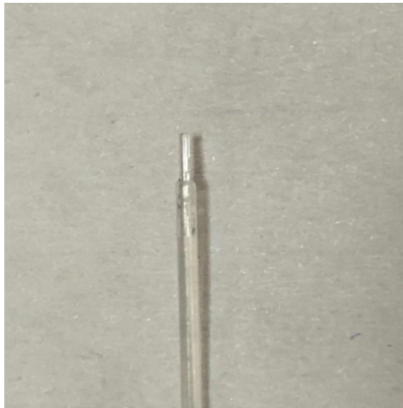
Рисунок 3 – Кончик оптоволоконна после снятия защитной изолирующей оболочки и обработки ручкой-скальвателем
