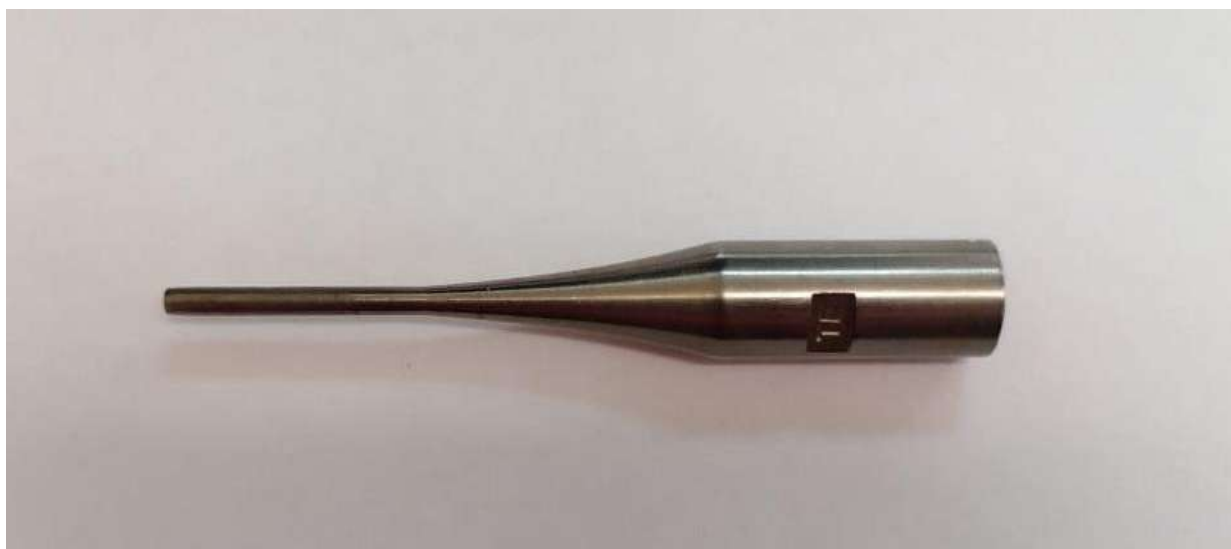
Рисунок 38. Ультразвуковой волновод с диаметром сечения 4 мм., для проведения эндауральный фонофорез раствора дексаметазона.
